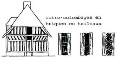
La maison du pays d'Auge se caractérise par une importante charpente couverte à l'origine par un toit de chaume. Elle possède des fondations peu profondes et un soubassement de 0,70 à 0,90 m en silex, calcaire ou grès.
